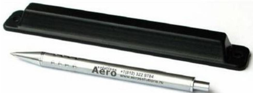
**Универсальная пассивная RFID-метка PatchTag™ предназначена для крепления как на диэлектрические (пластик, стекло и т.д.), так и на металлические поверхности маркируемых объектов. Ключевая отличительная особенность этой метки – оригинальная конструкция антенны (на неё получен Российский патент) с коэффициентом усиления 6.5 dBi.**
