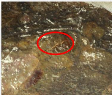
Коррозионные поражения углеродистой и низколегированной стали
