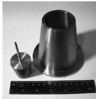
Общий вид отклоняющих конусов
