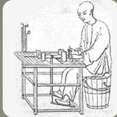
Древнекитайский токарный станок с ножным приводом
