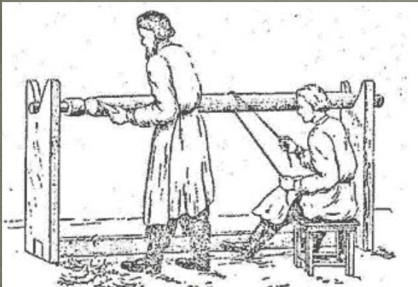
Древнеегипетский токарный станок приблизительно 300 век до нашей эры
