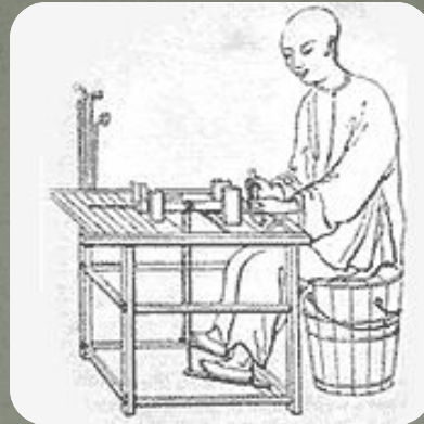
Древнекитайский токарный станок с ножным приводом
