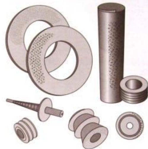
Инструмент с биметаллическим алмазным режущим слоем (БАРС)
