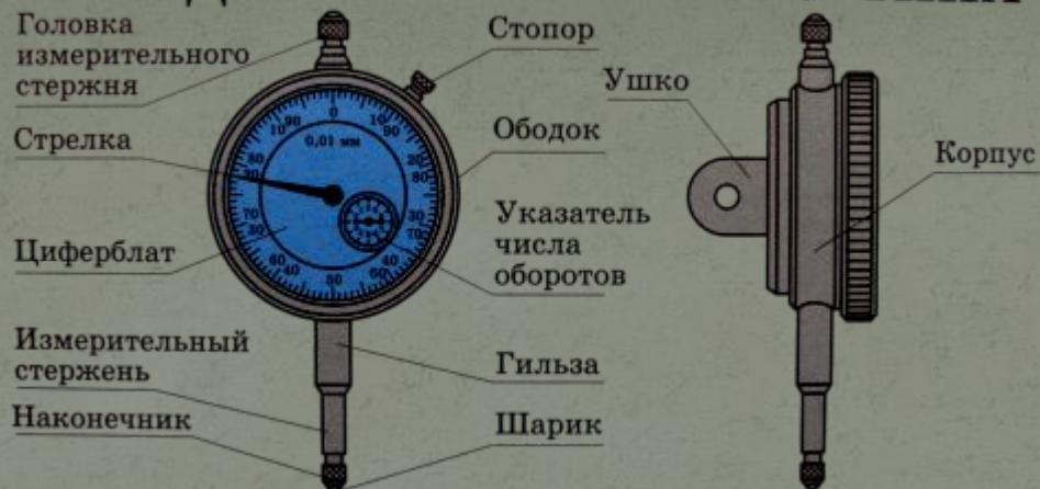
Измерение индикаторной скобой
