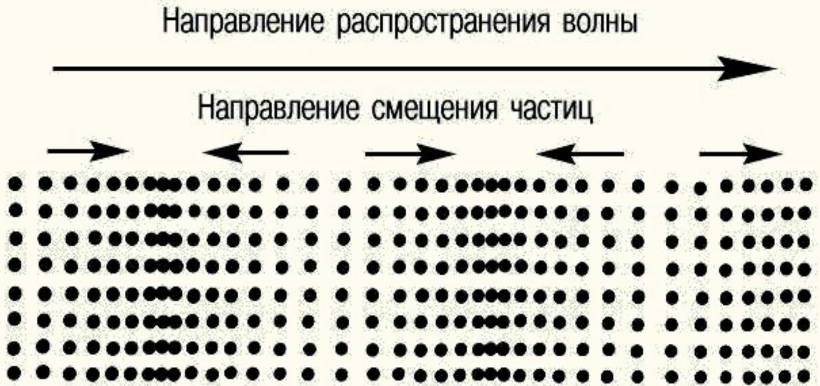
Из рисунка видно, что при распространении продольной волны в среде одни частицы двигаются к положению равновесия, а другие от положения равновесия, поэтому внутри вещества создаются чередующиеся сгущения и разрежения частиц,
