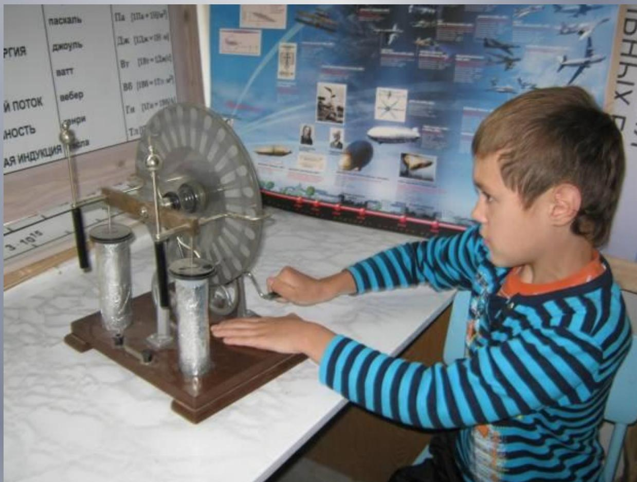
Это приспособление называется электрофорная машина. Она предназначена для физических опытов при получении электрических разрядов.
