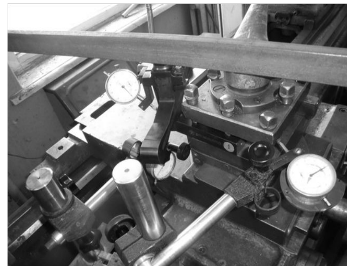
Структурная схема измерения деформацией суппорта при действии рабочей силы по горизонтальному и вертикальному направлениям
