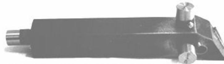
Крепление пьезоакселерометров на резце при проведении экспериментов
