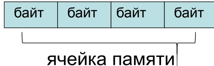
Ячейка – это часть памяти, вмещающая в себя информацию, доступную для обработки отдельной командой процессора.
