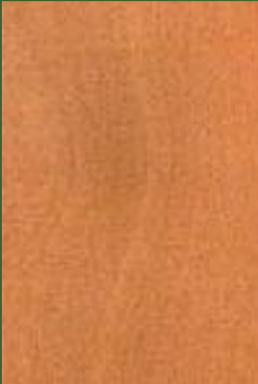
Древесина дикорастущей груши значительно лучше сортового дерева. У молодых деревьев древесина почти белая, темнеет с возрастом. Древесина груши характеризуется средней плотностью, твердостью, однородным строением. Древесина тяжелая, хорошо обрабатывается и полируется. Из нее выполняются имитации под черное дерево. Текстура древесины тонкая, со слабовыраженными порами и рисунком годовых колец. Груша имеет сильную тенденцию к короблению, поэтому ее сушка должна производиться очень медленно.
