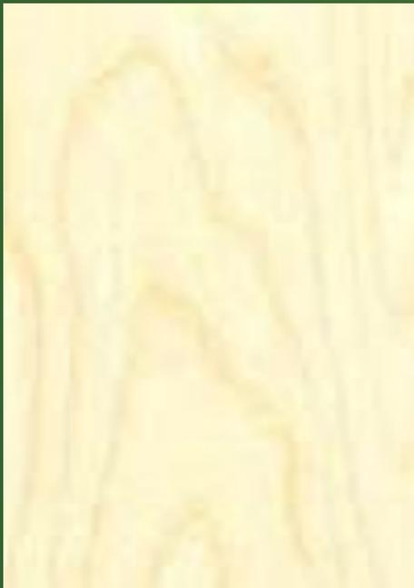
Цвет древесины белый с розоватым или желтоватым оттенком. Сердцевинные лучи узкие, различаются только на радиальном разрезе. Годичные слои различаются плохо. Древесина умеренно твердая, однородная по плотности, хорошо обрабатывается. Обладает большой сопротивляемостью раскалыванию, легко поддается имитации под ценные породы, хорошо окрашивается и полируется, пропитывается антисептиками. Древесина березы подвержена короблению и загниванию.
