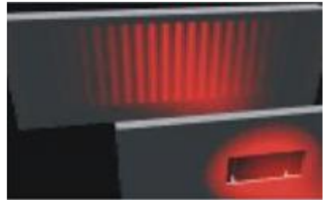
Интерференционные полосы в опыте Юнга.
