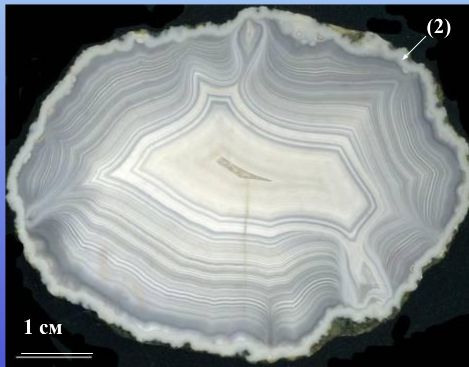
Агат с облекающим типом зональности и несколькими подводящими и отводящими каналами. Колл. Ю.Т. Ильина. (2) – зона, сложенная опалом, кристобалитом, цеолитом.
