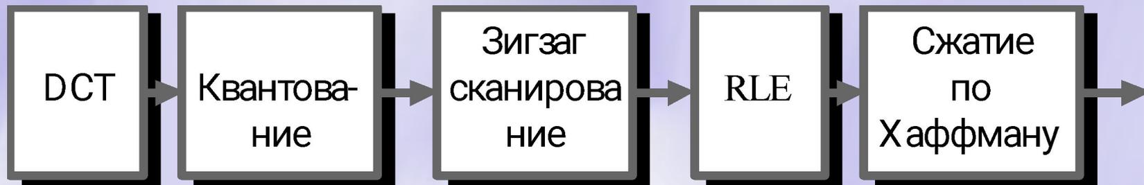
Классическая схема сжатия межкадровой разницы очень похожа на сжатие JPEG: блоки 8x8 сжимаются помощью дискретного косинусного преобразования
