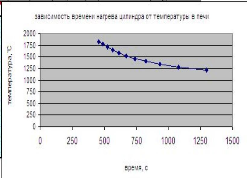
Расчет времени нагрева цилиндра при варьировании коэффициента теплоотдачи:
