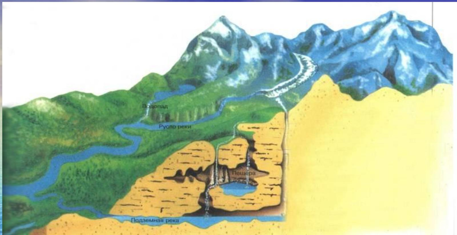
***Грунтовые воды медленно перемещаются, по порам водоносного слоя в сторону уклона водоупорного слоя. На склонах, в оврагах, речных долинах они выходят на поверхность, образуя источники(родники).***
