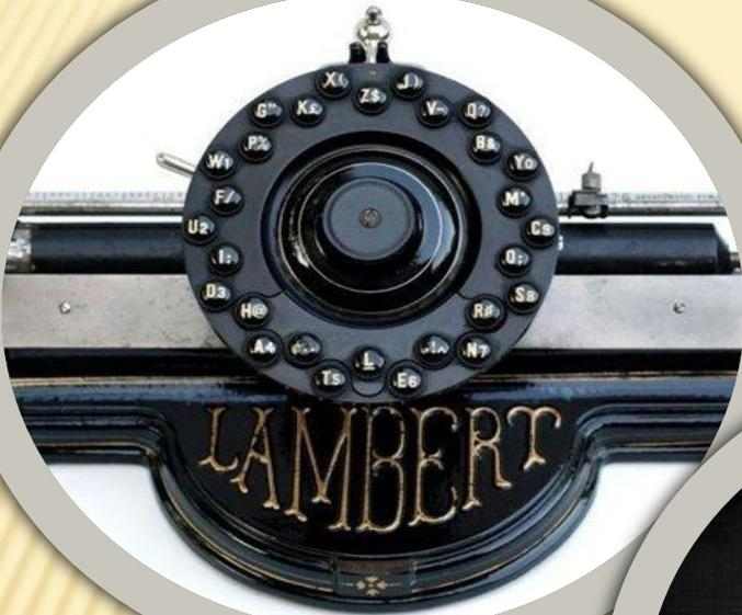
Печатные машинки без клавиатуры. Одна рука работает с указателем, другой выбирает букву в индексе, третья рука нажимает рычаг для печатания буквы на бумаге.
