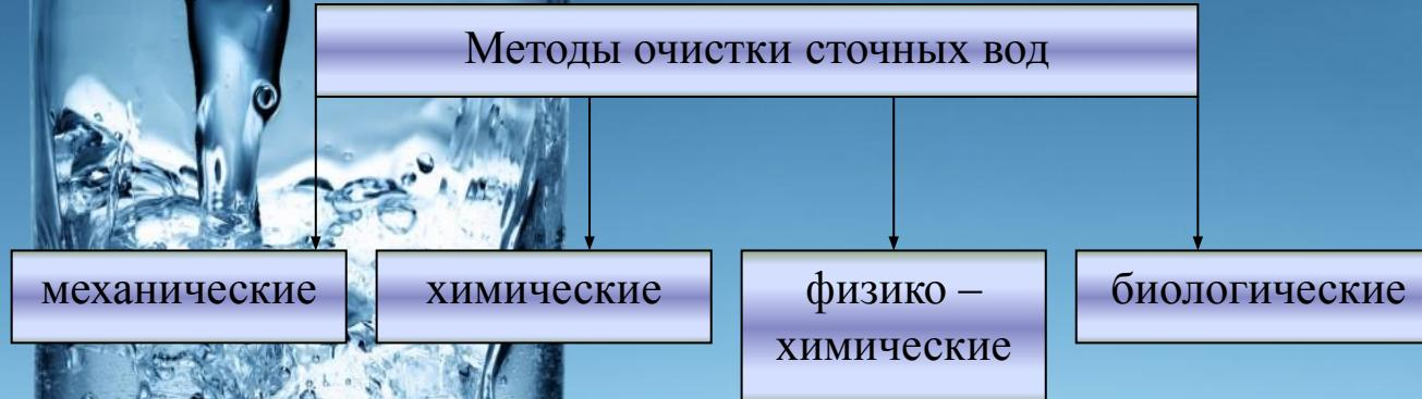
Сущность **механического метода очистки** состоит в том, что из сточных вод путем отстаивания и фильтрации удаляются имеющиеся примеси. Механическая очистка позволяет выделить из бытовых сточных вод до 60 – 75% нерастворимых примесей, а из промышленных до 95%, многие из которых (как ценные материалы) используются в производстве.
