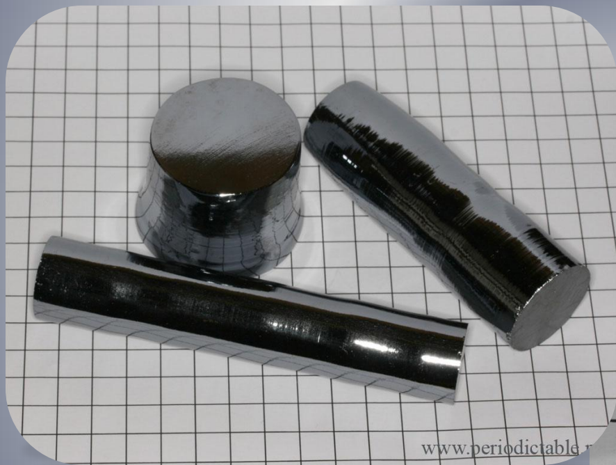
Заготовки из кремния
