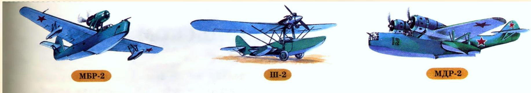
Первый советский серийный гидросамолёт Ш-2, созданный конструктором В.Б.Шавровым, был выпущен в апреле 1932 года. Ш-2 самолёт-амфибия, летающая лодка-полутораплан с двигателем М-11 мощностью 100 л.с.,- имел трёхместную кабину и убирающиеся шасси, на осях которого могли устанавливаться колёса или лыжи. Уборка и выпуск шасси осуществлялись тросовым приводом из кабины. Вес нагрузки- 277 кг., максимальная скорость – 139км/час, дальность полёта -420 километров.
