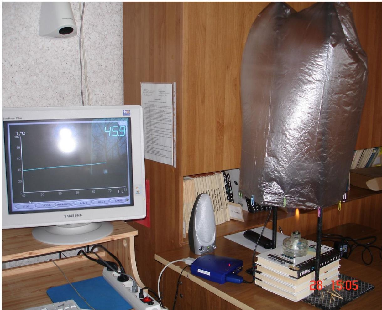
Экспериментальная установка для определения грузоподъёмности модели монгольфера.
