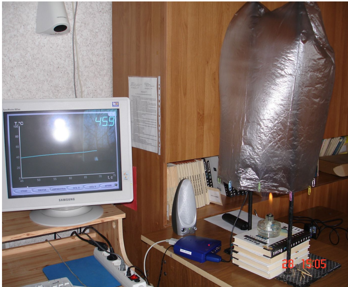
Экспериментальная установка для определения грузоподъёмности модели монгольфера.
