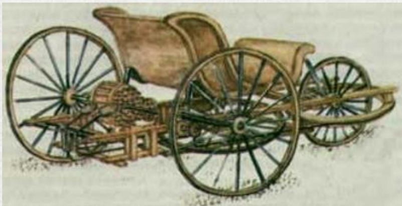
А ещё Кулибиным была изготовлена **повозка-самокатка** (1791 г.), которая имела тормоз, коробку скоростей, подшипники **(как в современном автомобиле!)**; повозка приводилась в движение человеком, нажимавшим на педали.
