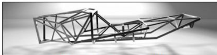
Трубчатый стальной кузов Local Motors
