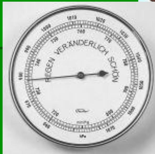
Барометр-прибор для измерения атмосферного давления.
