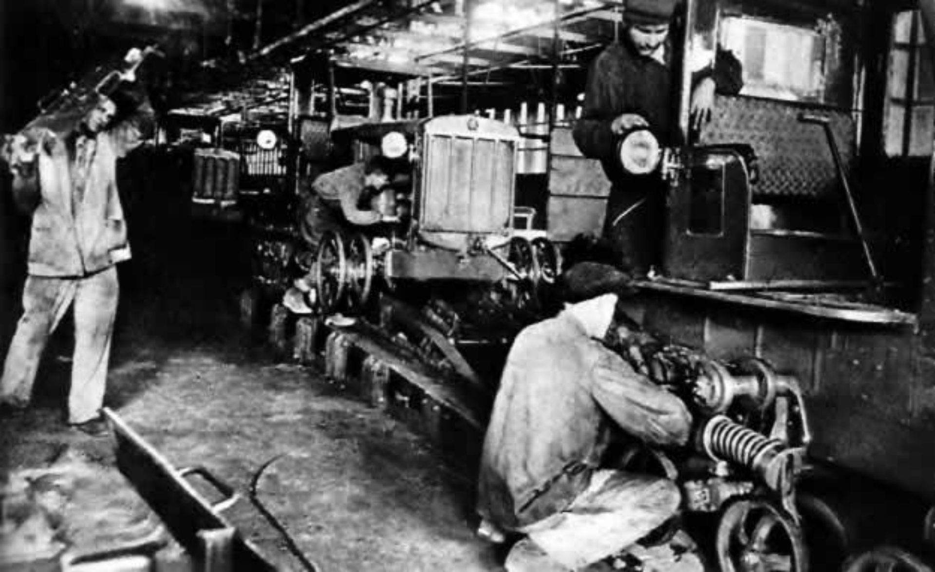
Сборка тракторов на конвейере Сталинградского тракторного завода
