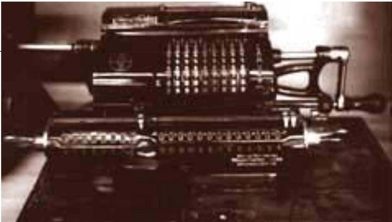
**Над арифмометром он начал работать в 1874 году, а в 1890 году налаживает их массовый выпуск. Их модификация "Феликс" выпускалась до 50-х годов. Главная особенность детища Однера заключается в применении зубчатых колес с переменным числом зубцов (это колесо носит имя Однера) вместо ступенчатых валиков Лейбница. Оно проще валика конструктивно и имеет меньшие размеры.**
