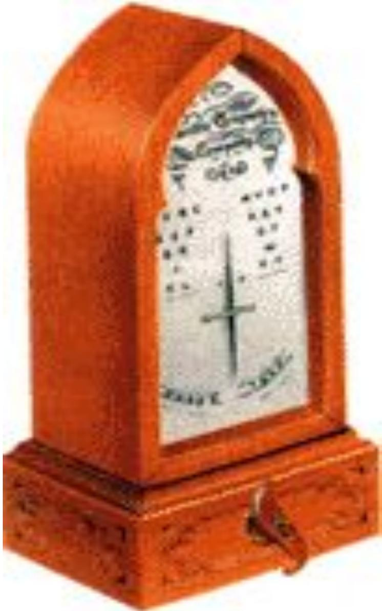
**Первый электрический телеграф создали в 1837 году английские изобретатели Уильям Кук (1806-1879) и Чарлз Уитстон (1802-1875). Электрический ток по проводам посылался на приемник. Сигналы приводили в действие стрелки на приемнике, которые указывали на разные буквы и таким образом передавали сообщения.**
