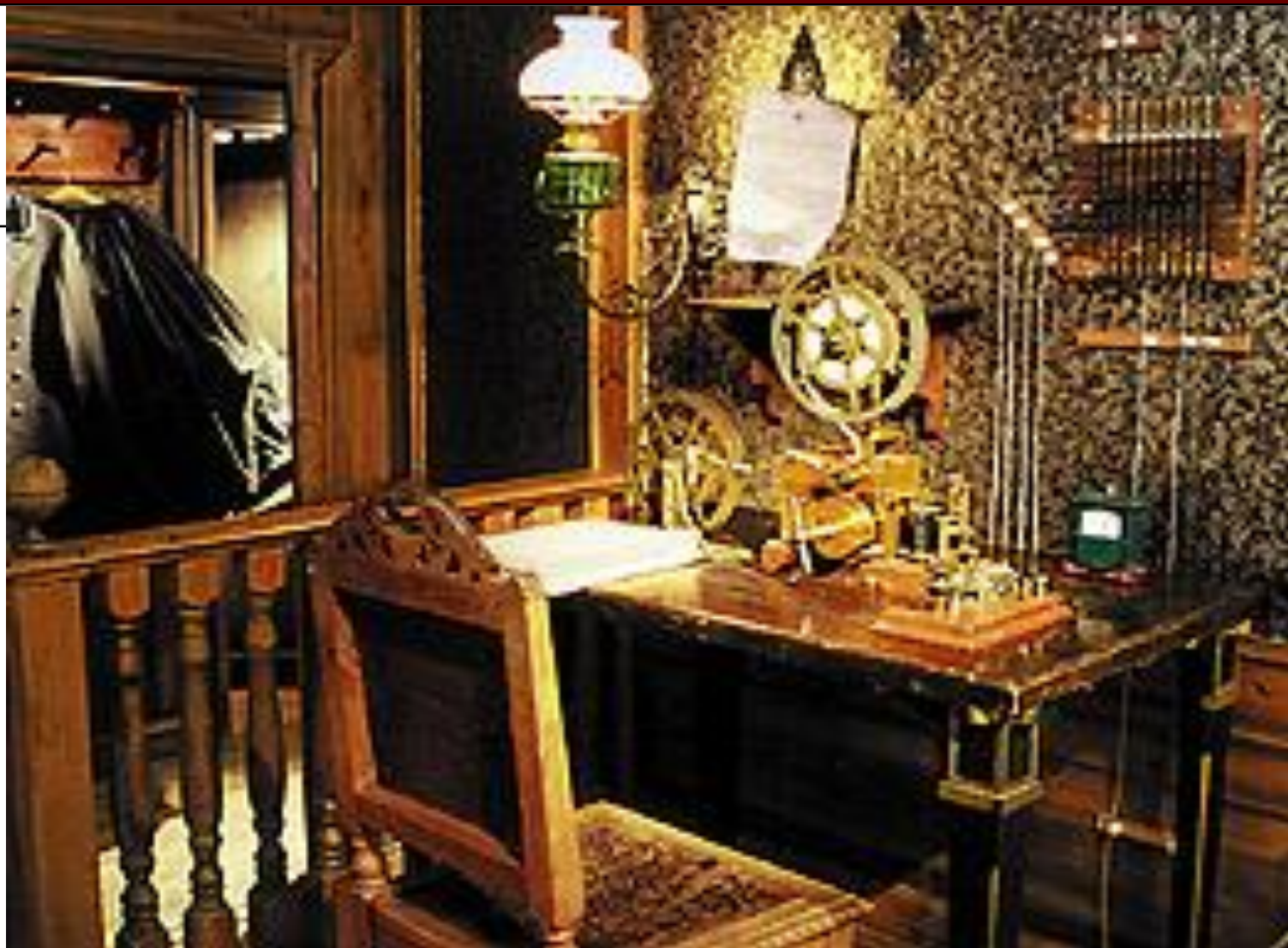
Телеграфный офис конца XIX века: аппарат Морзе, коммутатор телеграфных линий, гальваноскоп
