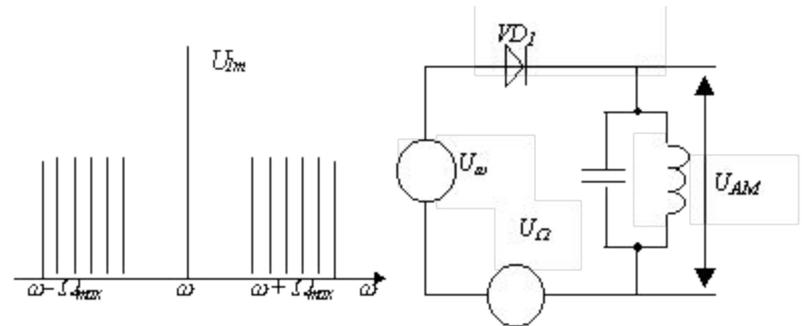
Рис. 6.7а. Спектр несущей, модулированной специальным звуковым сигналом
