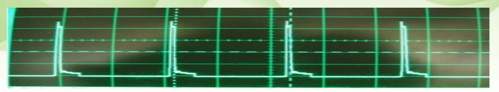
Ширина импульсов изменяется в зависимости от изменения концентрации и температуры
