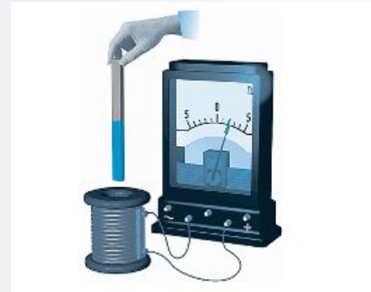
Возникновение тока при действии пост. магнита на катушку
