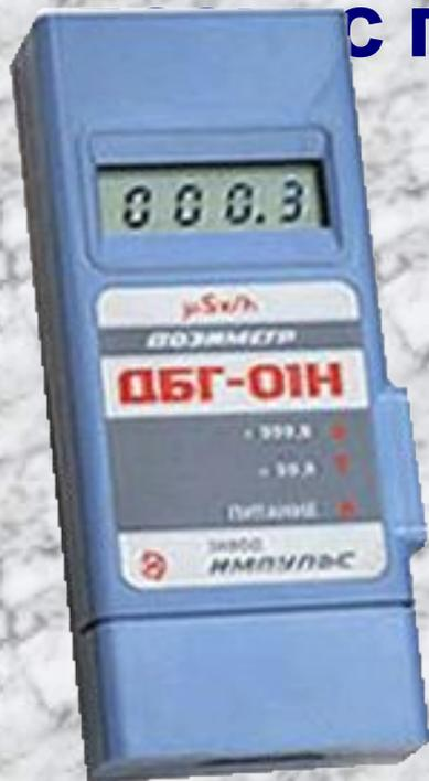
Применяется для оперативного радиационного контроля на различных предприятиях при работах, связанных с источниками ионизирующих излучений.
