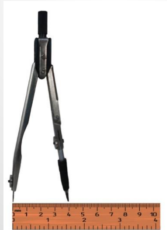
Отмеривание радиуса окружности по линейке
