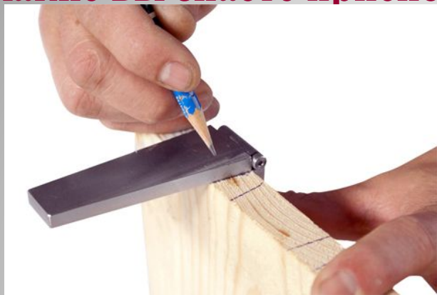
Шаблон для разметки под ласточкин хвост
