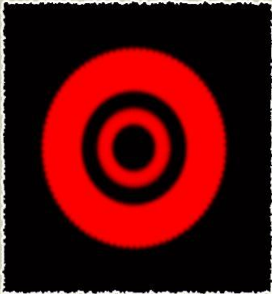
Дифракционная картина от круглого отверстия
