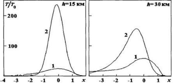
Рисунок 1.2 – Распределение электронной температуры  $T$  в ионизированном образовании на различных высотах  $h$  атмосферы в сопровождающей импульс системе координат
