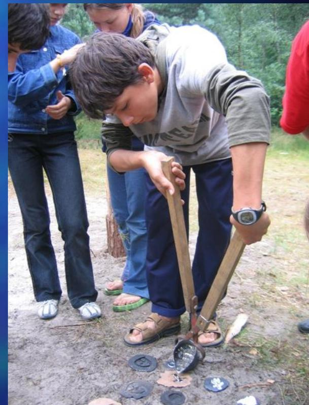
Отливка металлических изделий с использованием готовых глиняных матриц.
