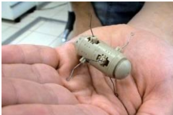
Самодвижущийся робот- эндоскоп
