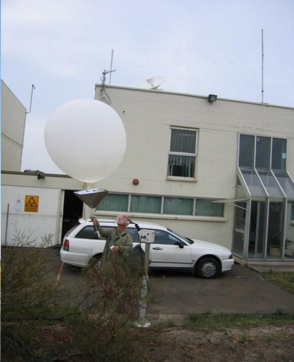
**Два-три раза в сутки с аэрологических станций поднимаются до высоты 30-40 км воздушные шары**
