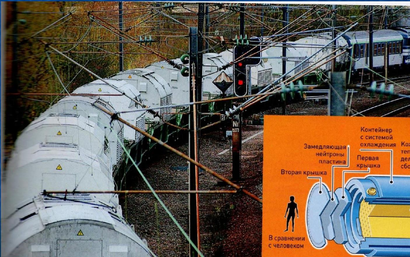
В поезде 12 контейнеров длиной 6,11 м, диаметром 2,48 м и весом 100 тонн (в пустом состоянии). Вес содержимого может достигать 12 тонн.
