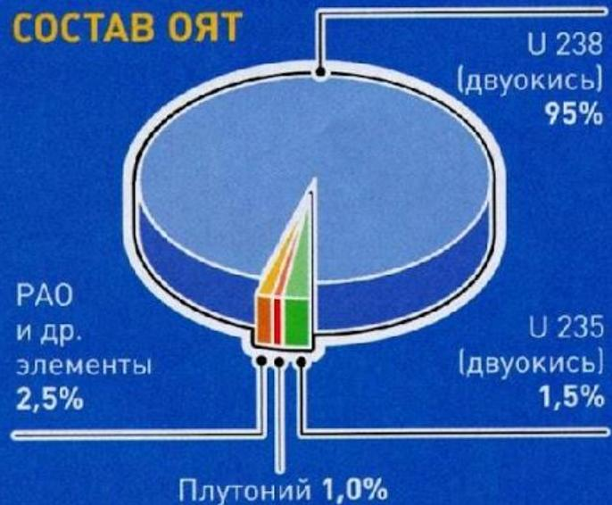
**97,5%** ОЯТ составляют энергетически ценные двуокиси изотопов урана ( $^{238}\text{U}$  и  $^{235}\text{U}$ ) и плутоний, наработанный в реакторе, которые могут быть использованы после длительного хранения.
