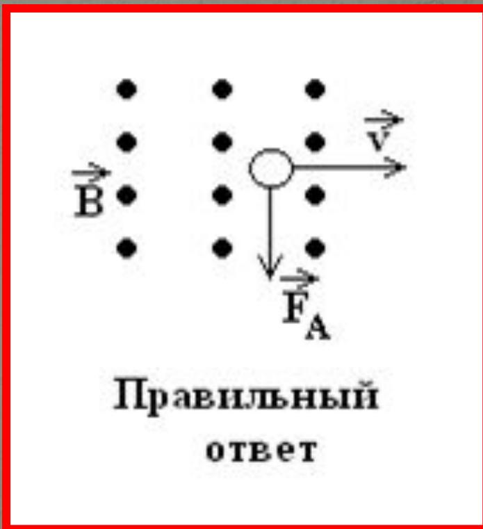
3. Определите направление силы Ампера на рис. 3.
