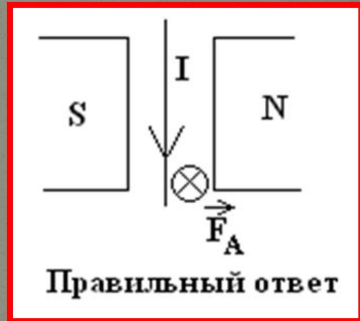
4. Определите направление тока на рис. 4.
