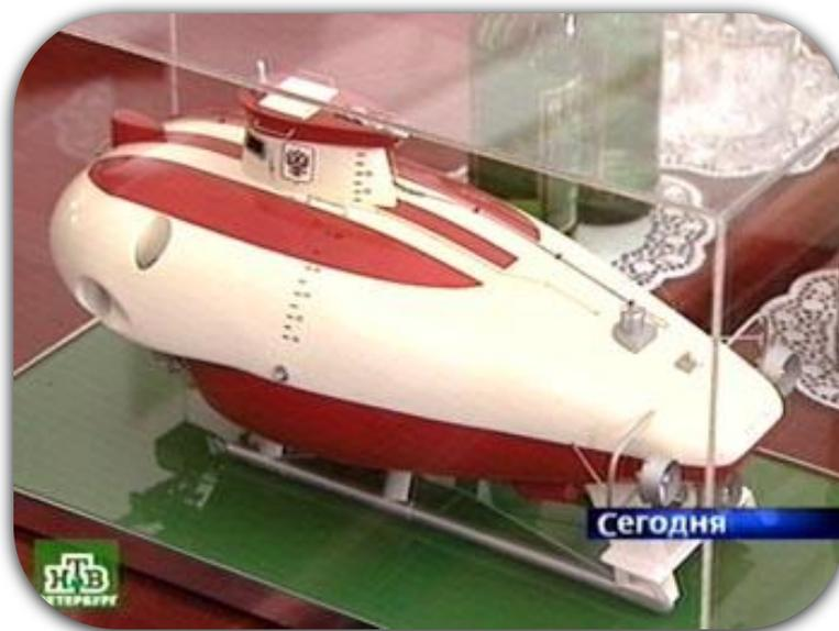
Автономный глубоководный аппарат «Русь» предназначен для поиска, обследования и видеосъемки объектов, находящихся под водой, доставки на грунт и подъема на поверхность оборудования массой до 200 кг
