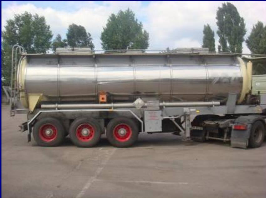
Большой резервуар, ёмкость, а также вагон или автомобиль с таким резервуаром для хранения и перевозки жидкостей.
