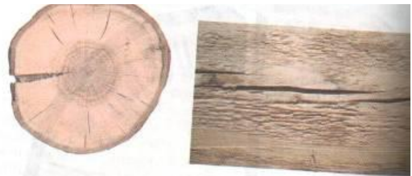
Рис. 12. Трещины древесины при несоблюдении правил сушки
