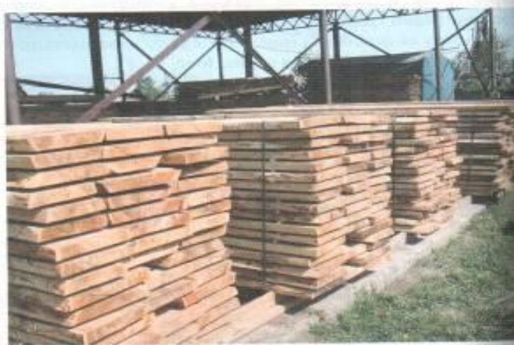
Рис. 14. Штабель пиломатериалов, сложенный под навесом в естественных условиях
