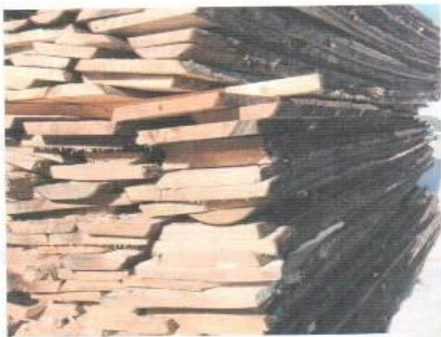
Рис. 9. Пример неправильной сушки древесины
