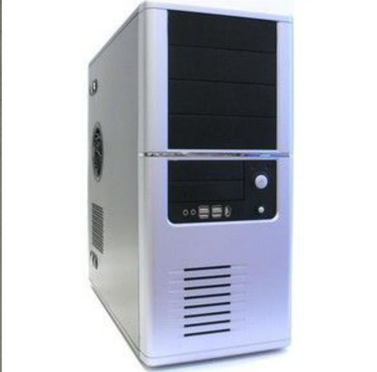
функциональный элемент, защищающий внутренние компоненты ПК от внешнего воздействия и механических повреждений, поддерживающий необходимый температурный режим внутри системного блока, экранирующий создаваемые внутренними компонентами электромагнитное излучение и является основой для дальнейшего расширения системы.
