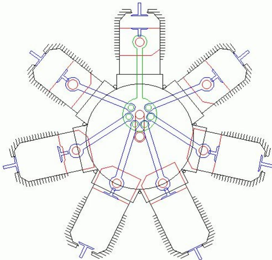
Один из самых популярных роторных двигателей военных самолетов времен Первой Мировой войны. Коленчатый вал этого двигателя крепился к корпусу самолета, в то время как цилиндры вращались вместе с пропеллером.
