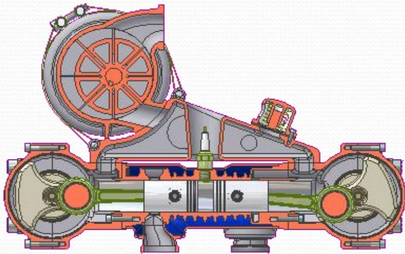
В автомобильной и мототехнике применяется для снижения центра тяжести. Оппозитное расположение поршней позволяет им взаимно нейтрализовывать вибрации, благодаря двигателю работает более плавно.
