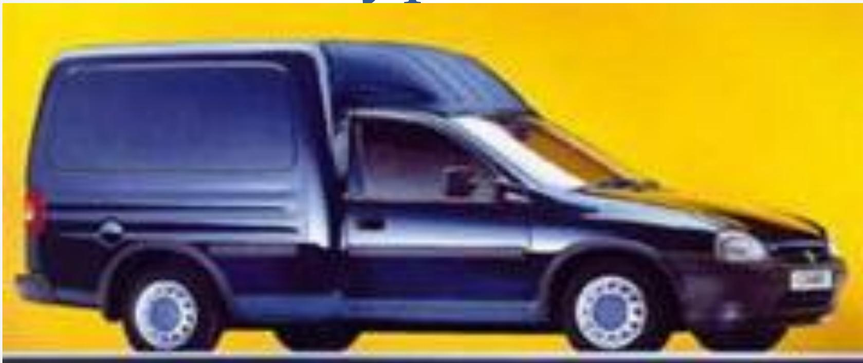
Кузов легкового автомобиля, внешне напоминающий универсал, однако в нем отсутствуют окна и боковые двери (например, одна из модификаций "Москвича-412" типа "каблучок").
