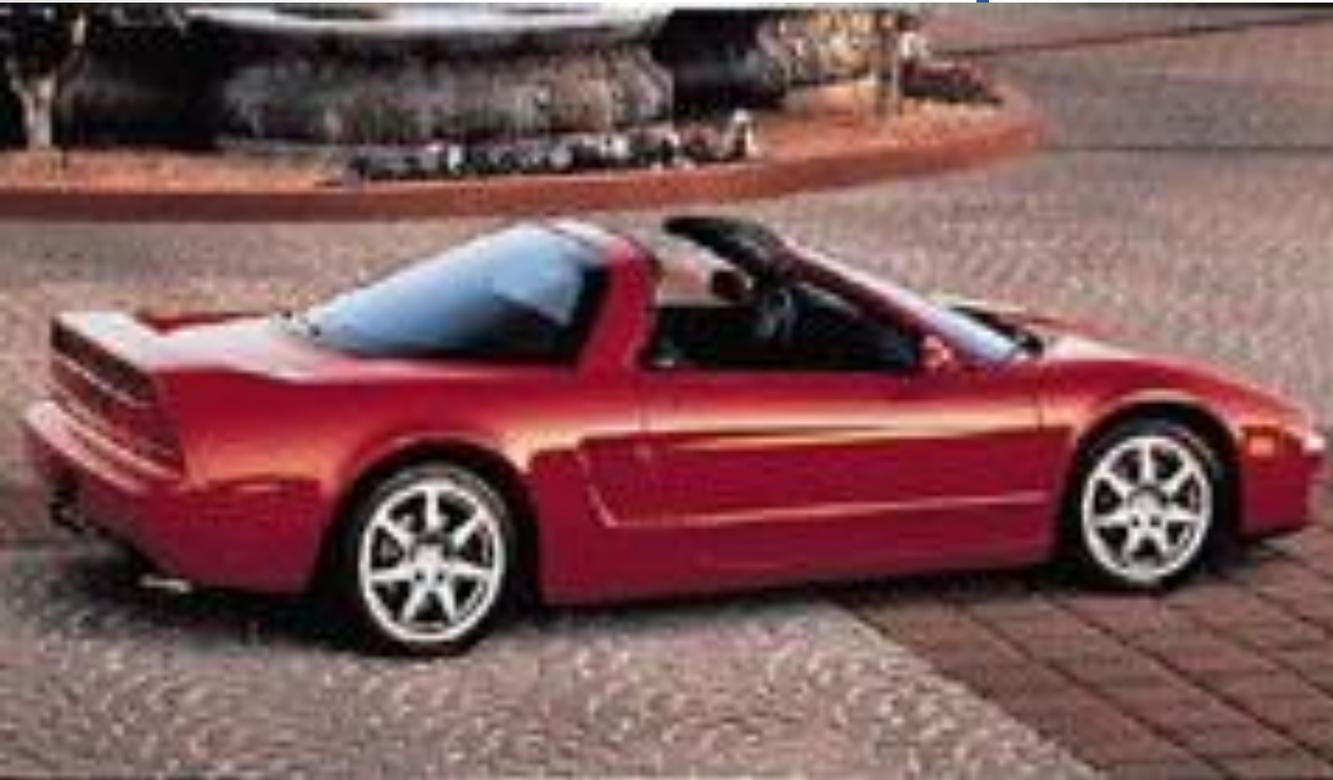
Очень редкий тип кузова. Здесь открытой остается лишь средняя часть автомобиля с мощной стойкой (мягкая крыша убирается в багажник), а задняя часть наглухо закрыта стеклом. Подобный тип кузова получил распространение на модели Porsche 911 Targa.
