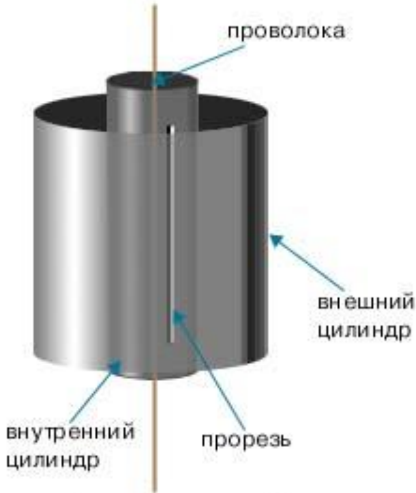
Схема установки Штерна.
