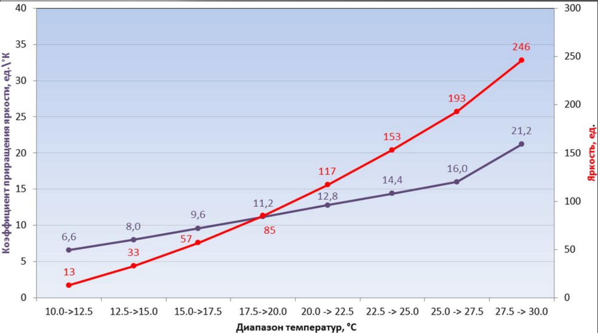
Как и в первом случае, построим распределение температурного коэффициента в зависимости от температуры, а также сравним с полученными результатами в первом опыте (посчитаны усредненные коэффициенты для отрезка в 5 °С):
