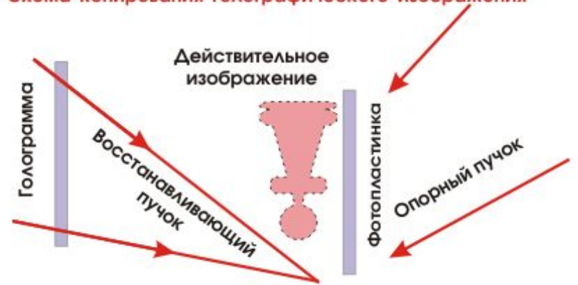
Схема копирования голографического изображения
