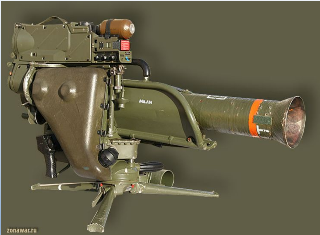
Рис. 15 ПУ ПТУР «Милан - 2». Масса ракеты с контейнером - 6,6 кг; масса боевой части – 2,98кг; максимальная скорость ракеты -200 м/с; дальность стрельбы: максимальная - 2000 м; диаметр корпуса ракеты – 116 мм; бронепробиваемость - 550 мм.
