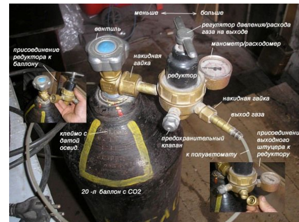
Баллон с углекислотой и с редуктором
