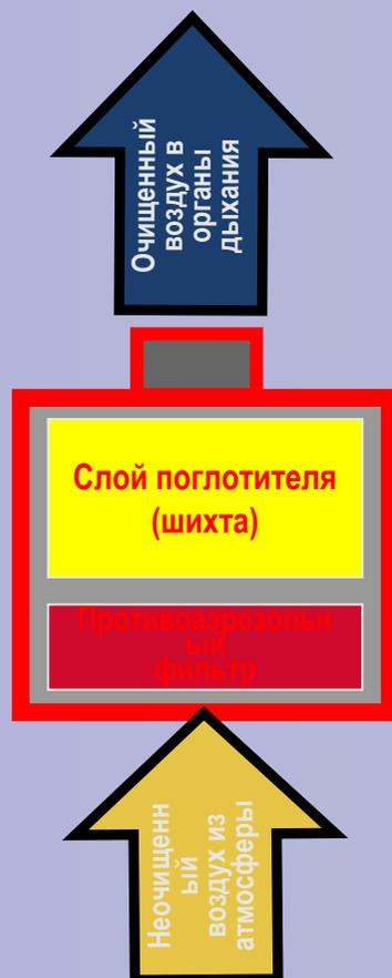
**Принцип действия** основан на способности активированного угля поглощать вредные примеси вдыхаемого воздуха (поглощающая поверхность 1 г активированного угля составляет 400 — 800 м<sup>2</sup>).
