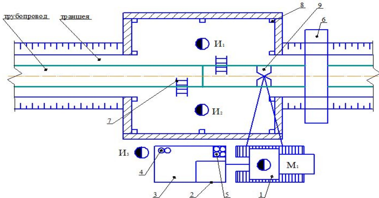
1 - трубокладчики; 2 - сани металлические; 3 - электроагрегат передвижной; 4 - рулоны полимерной ленты; 5 - баллоны с газом; 6 - инвентарный мостик; 7 - лестница приставная (H = 2 м); 8 - щиты крепления; 9 - мягкое полотенце; М - машинист трубокладчика; И<sub>1</sub> – И<sub>2</sub> - изолировщики; ● - рабочее место исполнителя.
