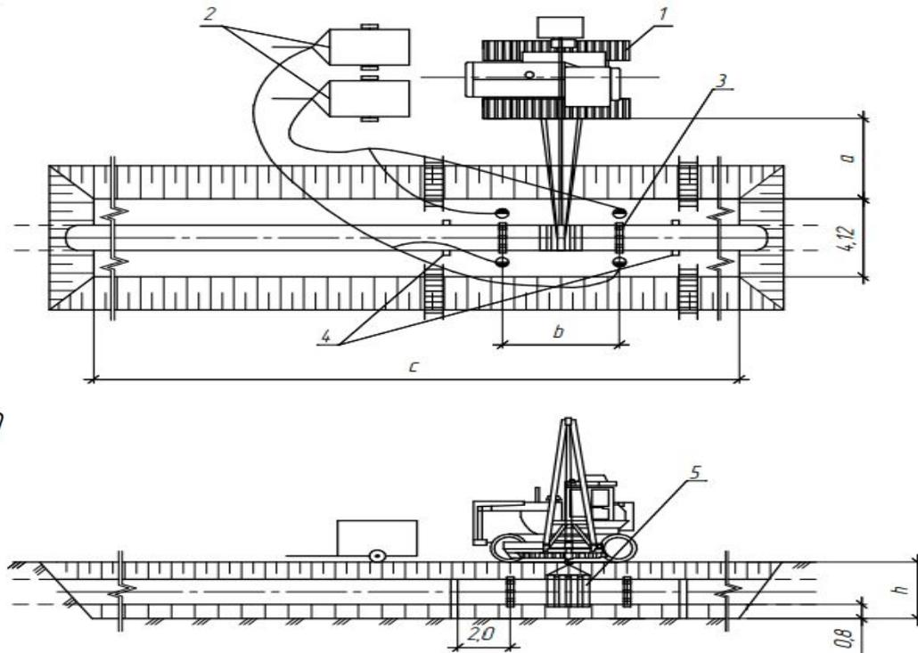
а-минимальное расстояние от основания до ближайшей опоры машины в ненасыпном грунте; б-длина монтируемой "катушки"; с-длина ремонтной траншеи; h-глубина ремонтной траншеи; 1-Трубоукладчик Komatsu D-355C-3 с грузоподъемностью 92,0т; 2- Агрегат сварочный АДД 2x2502; 3- Центратор звенный наружный ЦЗН-1421; 4- Устройство поддерживающее УП 1420; 5- Полотенце мягкое МВП-12,0 для труб  $\varnothing 1420$  мм.
