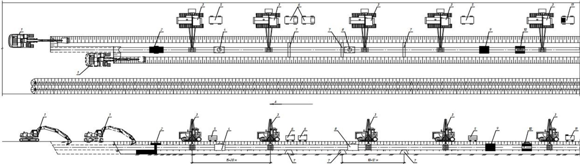
1-Экскаватор Komatsu PC220/LC-7; 2- Машина подкопная; 3-Трубоукладчик Komatsu D-355C-3; 4- Машина для предварительной очистки трубопроводов; 5-Дизельная электростанция; 6-Агрегат сварочный; 7-Устройство поддерживающее УП1420; 8-Машина для финишной очистки ПТ-НН 1420ФО; 9-Агрегат нагревательный; 10-Изоляционная машина МИ-3; 11-Передвижная лаборатория контроля качества
