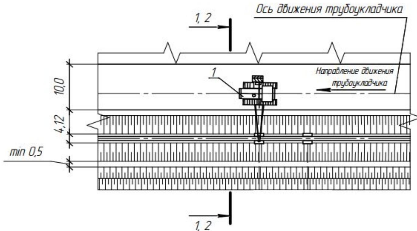
1- Трубоукладчик Komatsu D-355C-3 с грузоподъемностью 92,0 т
