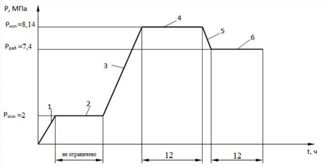
1, 3 – подъем давления; 2 – осмотр трубопровода; 4 – испытание на прочность; 5 – снижение давления; 6 – испытание на герметичность;
