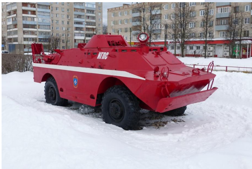
Пожарный вариант БРДМ-2РХ (Бронированная машина радиационной и химической разведки).
